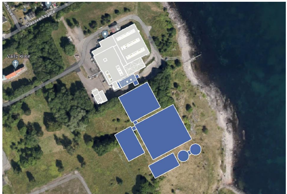
Figur 6. Tønsberg rensanlegg med nytt areal for forbehandling, forsedimentering, nitrogenfjerning og slambehandling (inkl. biogass) (blå bygg).
